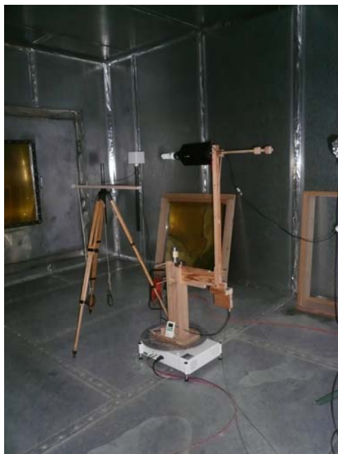
Figure 3.2.2 : Goniomètre pour la recherche de la direction d'émission maximale et pour la mesure des champs électrique et magnétique
