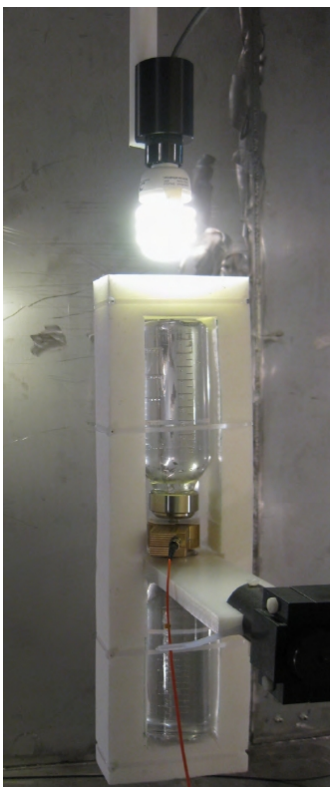
Figure 2 : Fantôme contenant du liquide, placé dans le champ électrique émis par la lampe à économie d'énergie. Les courants induits dans le fantôme sont mesurés au moyen de la pince fixée au milieu. La distance entre la lampe et le fantôme est de 2 cm.
