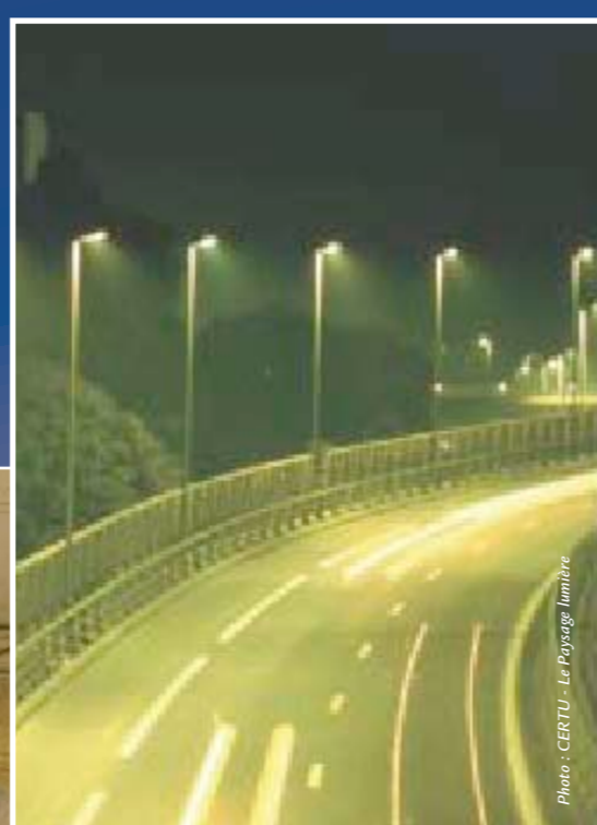
Voie rapide Chaussée Lampe au sodium haute pression 150, 250 ou 400 W
